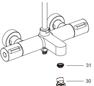
检查并确保所有的衔接处都已拧紧，确保手柄在关的位置。
