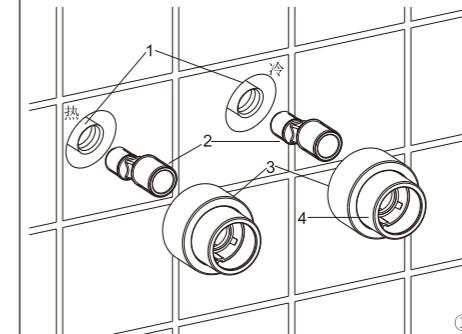
在螺纹上缠绕足够的密封胶带或涂合适的密封膏，安装两个接头(2)到冷热供水管上。
