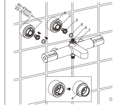
情形二：当接头(2)凸出墙面的距离是43~47mm时，将滤网(5)装到接头内。扔掉垫片(6)。
